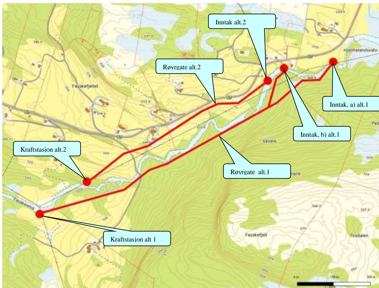
Figur 3. Kartutsnittet viser i grove trekk dei viktigaste naturinngrepa i form av inntak, rørgater og kraftstasjon for dei ulike alternativa.
