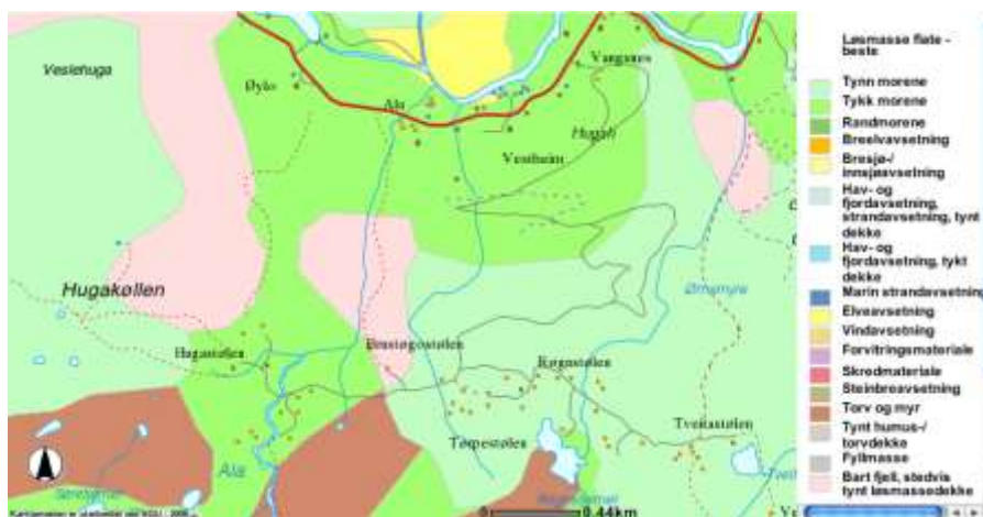
Figur 7. Lausmassekartet syner at den nedste delen av utbyggingsområdet har lausmassar i form av tykk morene og det same gjeld der det skal byggjast veg sør for inntaket i Ala. Resten av området har delvis bart fjell, for det meste med tynt lausmassedekke. (Kjelde NGU).
